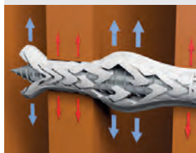
Funkcjonowanie kołka SXRL w pustakach
